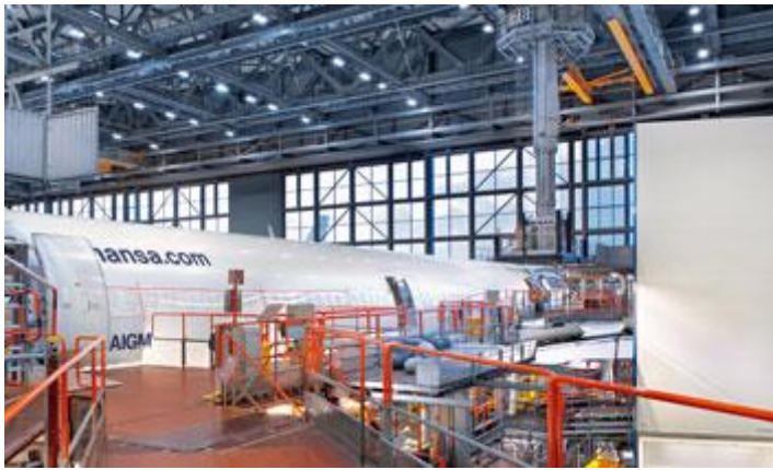
Direkter Verbindungsgang vom Flugzeug zum Lean-Lift-System.
