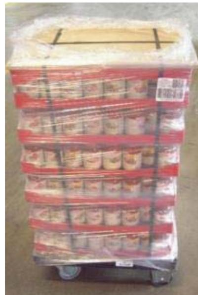
Ein Kraftschluss zwischen dem Ladungsträger und dem Display sowie die Bänderung und / oder Folierung für den Transport gewährleisten die Stabilität des Gebindes.
