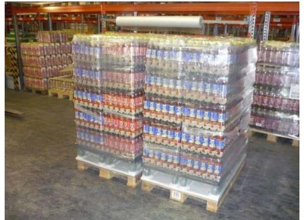
Das 4er Gebinde wird mit dem Gabelstapler auf das Adapter Tray gehoben. Der Orientierungspunkt für den Gabelstaplerfahrer ist hierbei die Ecke des Euro Dollies sowie die äussere Kante der Europalette.
