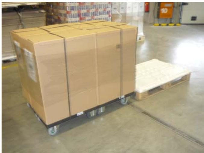
Beim Schieben von einzelnen Dollies auf die Verloaderampe von LKW's oder ähnlichem ist darauf zu achten, dass die Laderampe leicht schräg angesteuert wird. Dadurch wird ein mögliches Kippen des Displays verhindert.
